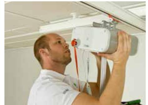
Der Motor kann einfach an der Deckenschiene angebracht oder davon abgenommen werden, um einen bequemen Transport zwischen Räumen mit minimalem Aufwand und ohne Leiter zu erleichtern.
