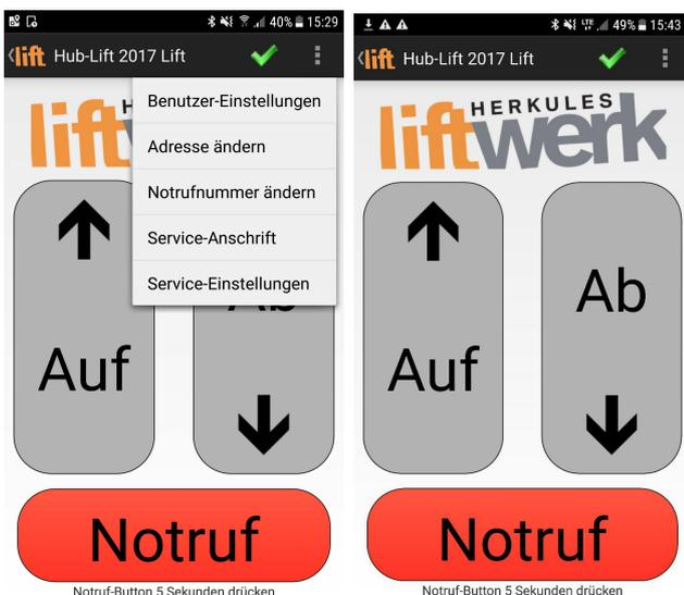
Mit dem originalen Zubehörbauteil *BLE-Modul* kann jeder Hublift der Serie MB ausgestattet werden. Sie ermöglichen eine komfortable Bedienung des Hublifts bei gleichzeitig hoher Betriebssicherheit einfach über fast jedes Smartphone. Das BLE-Modul arbeitet dabei nach dem Bluetooth Low Energy Standard und sendet im 2,4-GHz Bereich.
